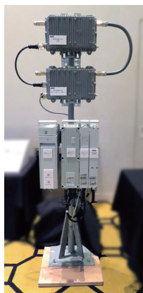
EDFAやOLT、無停電電源装置などをワンパッケージ化した分散サブセンター
